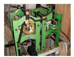
Der Turm enthält eine Uhr mit Schlagwerk, die in den früheren Jahren noch aufgezogen werden mußte.1972 wurde ein elektrisches Läutewerk eingebaut.
